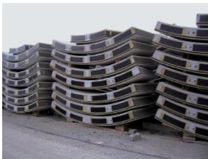
Las dovelas cuentan con juntas de estanqueidad en sus caras laterales.
