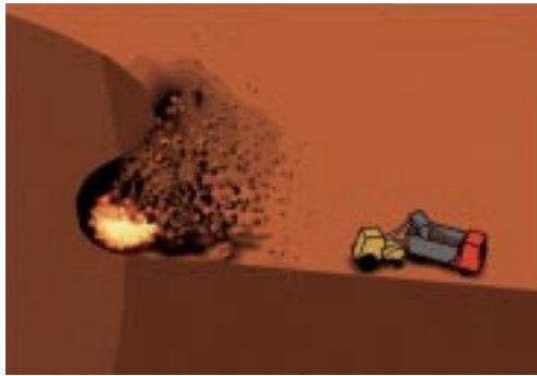
Con explosivos se realiza la primera perforación del terreno
