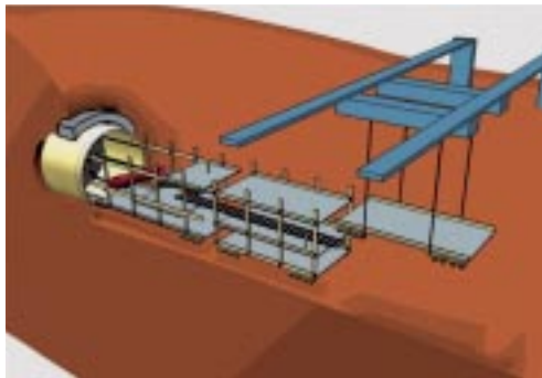
A continuación del escudo se efectúa el montaje del resto de la maquinaria.
