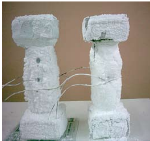
FIGURA 1. PRUEBAS DE PINTURAS INTUMESCENTES
