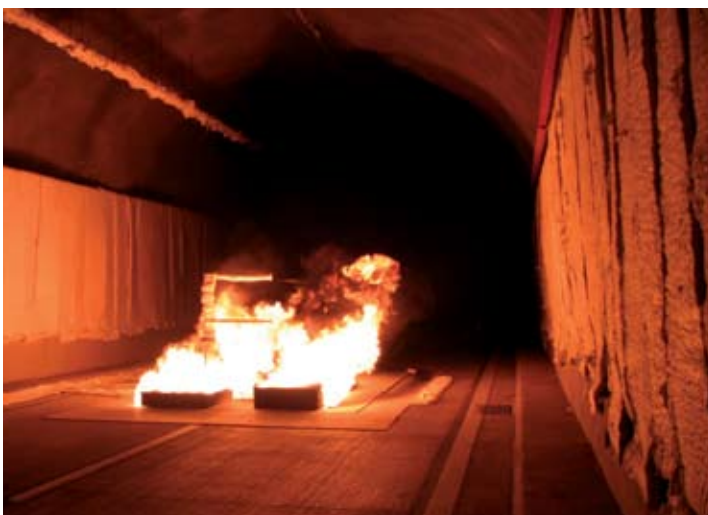
Prueba de humos calientes en el túnel San Cristóbal, donde el sistema de detección de incendios no funcionó como se esperaba.
