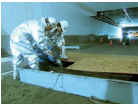
Preparación del recipiente con combustible para la prueba de humos calientes.
