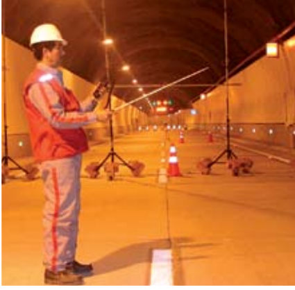
Izquierda. Ensayos al vacío al interior de un túnel para medir la velocidad del aire sin la generación de incendios ni la presencia de humo.
